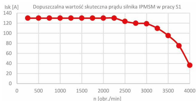
Rys. 3. Dopuszczalna wartość skuteczna prądu silnika IPMSM w pracy S1
