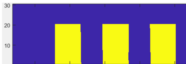
Rys. 3. Zobrazowanie danych uzyskanych z kurtyny pomiarowej podczas obserwacji obiektów typu: walec, prostopadłościan o podstawie kwadratowej oraz prostopadłościan o podstawie sześciokątnej (usytuowanie obiektów jak na rys. 2) [opracowanie własne]
