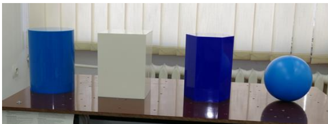
Rys. 2. Ruchoma scena pomiarowa z obiektami typu: walec, prostopadłościan o podstawie kwadratowej, prostopadłościan o podstawie sześciokątnej oraz kula, ustawionymi w pozycji pionowej [fot. autor]
