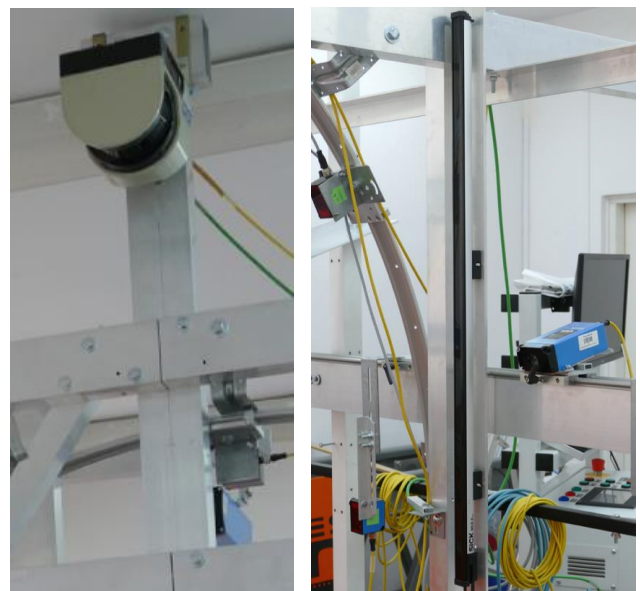
Rys. 1. Skaner 2D (z lewej) oraz kurtyna-bariera pomiarowa (z prawej) na stanowisku badawczym [fot. autor]
