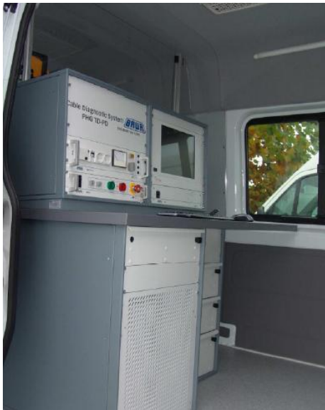
Rys.6. Aparatura do badań diagnostycznych firmy Baur [7]
