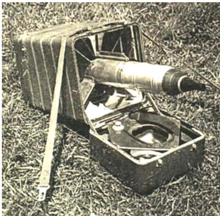
Fot. 4. W kwietniu 1961 r. zapadła decyzja o kontynuowaniu prac przy pocisku o mniejszych wymiarach, jako broni tylko przenośnej. Na zdjęciu RPP-2 Diamant-2 w skrzynkowej wyrzutni będącej jednocześnie środkiem transportu dla obsługi
