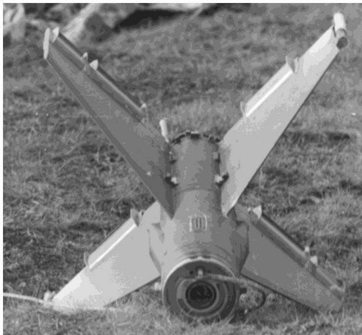
Fot. 6. Pocisk 3M6 Trzmiel z rozwiniętym przewodem naprowadzania
