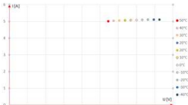
Rys. 14. Zmiana położenia punktów MPP na charakterystyce I=f(U)
