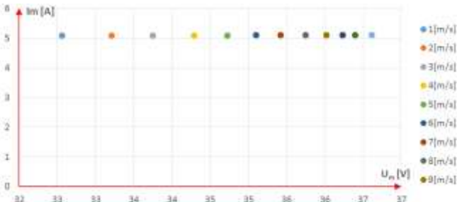
Rys. 25. Zmiana położenia punktów PMM na charakterystyce prądowo-napięciowej dla wybranych prędkości wiatru
