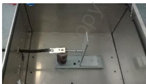
c) układ generujący wyladowania typu powierzchniowego
