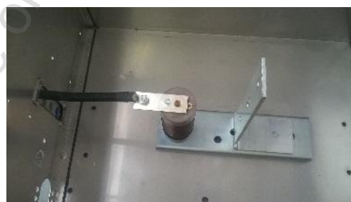
b) układ generujący wyladowania typu korona
