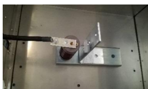
d) układ generujący wyladowania typu wewnętrznego
