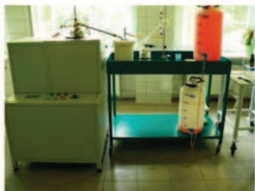
Instalacja do badań pirolizy paliw w złożu stałym
