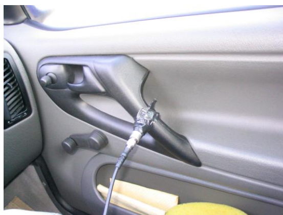
Rys. 3. Sposób i miejsce pomiaru drgań działających na pasażera, (a) kierunek Z, (b) kierunek X
