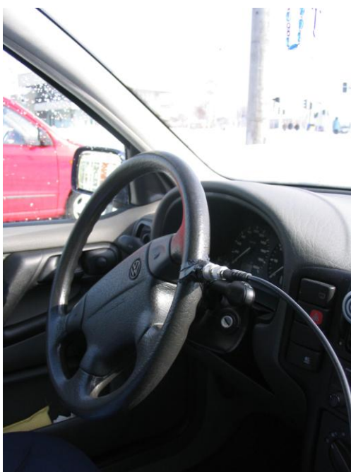
Rys. 2. Sposób i miejsce pomiaru drgań działających na kierowcę, (a) kierunek Z, (b) kierunek X
