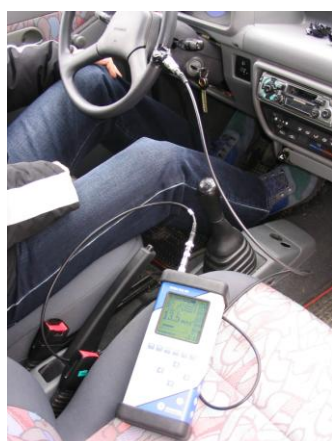
Rys. 4. Sposób i miejsce pomiaru drgań działających na kierowcę, (a) kierunek Z, (b) kierunek X
