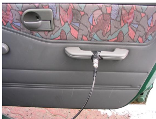
Rys. 5. Sposób i miejsce pomiaru drgań działających na pasażera, (a) kierunek Z, (b) kierunek X
