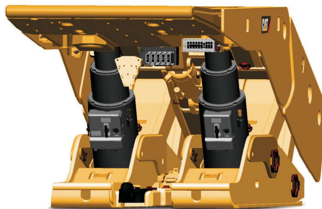
Rys. 14. Sekcja ścianowej obudowy zmechanizowanej kompleksu Bogdanka I – podporność sekcji 6413 kN Fig. 14. Face shield from plow system of Bogdanka I – yield of 813 tons
