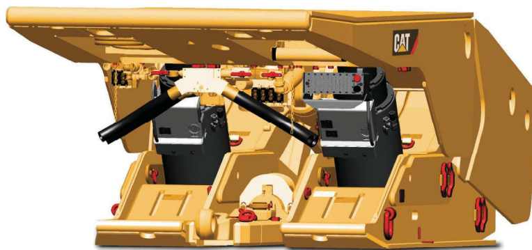
Rys. 10. Sekcja obudowy zmechanizowanej z kompleksu strugowego kopalni Pinnacle – podporność sekcji 5162 kN
