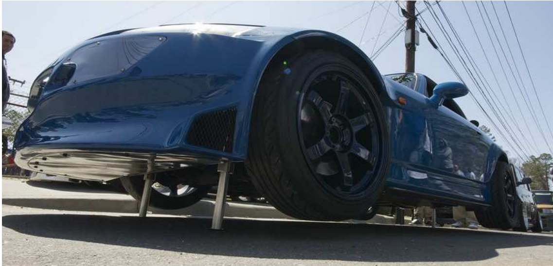
Rys. 1. Widok pojazdu sportowego podniesionego za pomocą pneumatycznego systemu z zasilaniem zewnętrznym [5]
