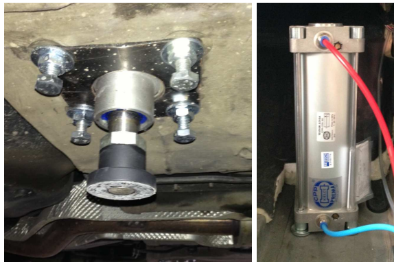
Rys. 5. Widok miejsca montażu siłownika z tyłu pojazdu (widok od spodu i wewnątrz)
