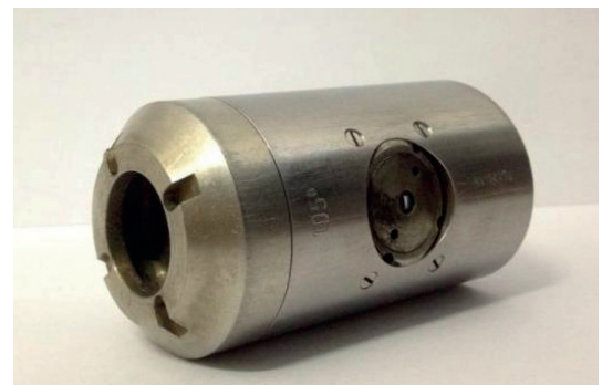
Rys. 2. Widok sondy wysokotemperaturowej z bocznym polem widzenia.
