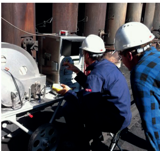
Rys. 6 Inspekcja wnętrza kanałów grzewczych pieców koksowniczych z użyciem sondy wizyjnej VIDEOFIL
