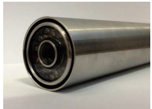
Rys. 3. Widok sondy niskotemperaturowej z osiowym polem widzenia
