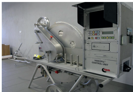
Rys. 4 Widok panelu sterującego i odczytującego rejestrowany przez głowicę obraz.
