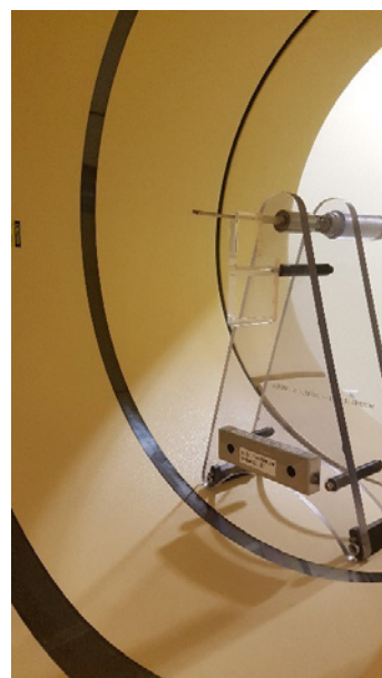
Rys. 1 Sposób umieszczenia źródła punktowego ^{22}\text{Na} w przybliżeniu w środku FOV z wykorzystaniem uchwytu dostarczonego przez producenta system PET w celu przeprowadzenia procedury sprawdzenia stabilności detektora Źródło: Materiał własny.
