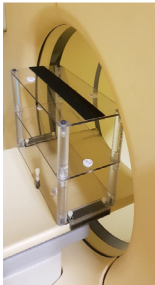
Rys. 9 Dedykowany fantom zawierający 6 źródeł pastylkowych ^{22}\text{Na} do oceny dopasowania cięć tomograficznych uzyskanych technikami PET i CT (lewa strona). Obrazy uzyskane w modalności CT (prawa strona góra) oraz PET (prawa strona dół) Źródło: Materiał własny.
