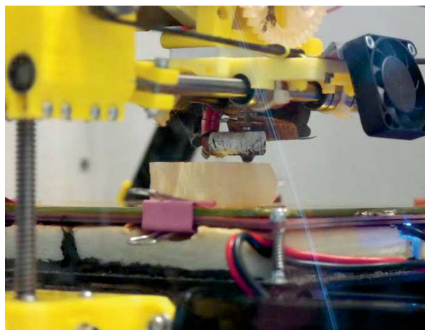
Rys. 5. Drukowanie fragmentu modelu tarczowatej chrząstki krtani za pomocą drukarki RepRap Mendel Max 1.5
