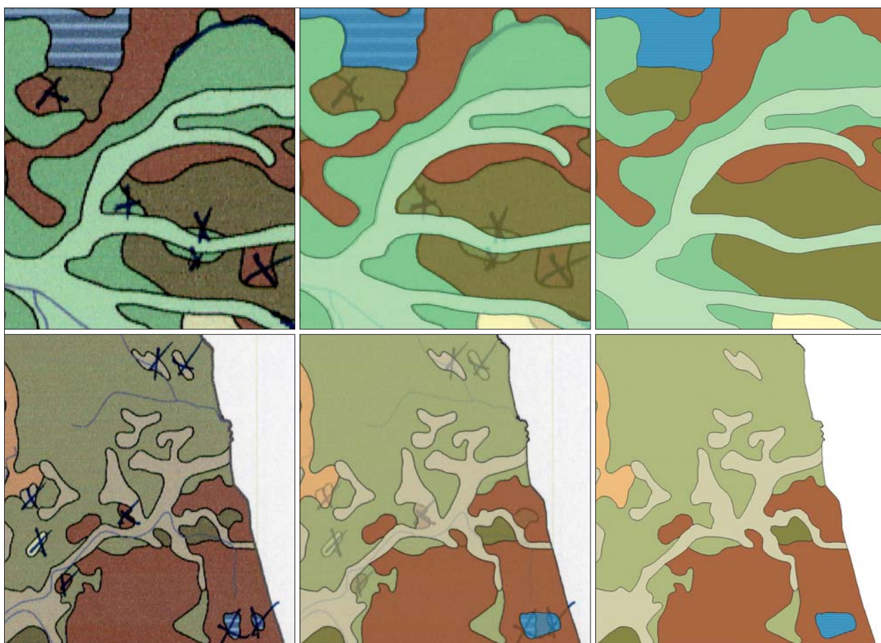
Ryc. 5. Porównanie wyników działania skryptu opracowanego przy użyciu oprogramowania FME ( Feature Manipulation Engine ) z generalizacją wydzieleni geologicznych wykonaną manualnie : po lewej stronie – generalizacja manualna , w środku – nałożenie obrazów uzyskanych po generalizacji manualnej oraz po wykorzystaniu skryptu FME, po prawej – generalizacja automatyczna wykonana za pomocą skryptu FME
