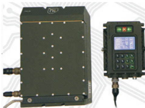
Rys. 3.5. Automatyczny gazosygnalizator PRS-1W [7]
