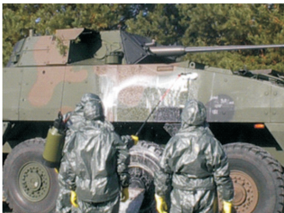
Rys. 5.3. Nanoszenie emulsji odkaźnika proszkowego z przenośnego przyrządu odkażającego z dyszami spieniącymi potrójnymi
