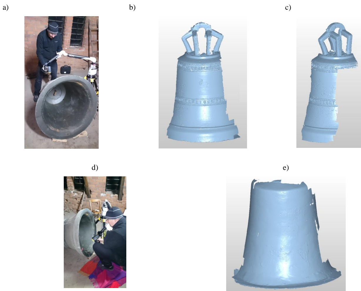
Rys. 15. Etapy digitalizacji Dzwonu Jan Fig. 15. Stages of digitization process of Bell "Jan"
