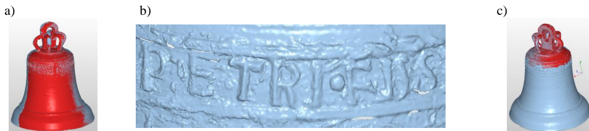
Rys. 13. Złożenie wszystkich cząstkowych chmur punktów Fig. 13. Assembling all the partial point clouds
