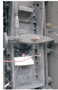
Rys. 3. Sposób zamocowania sond ciśnieniowych w drzwiach piecowych:
