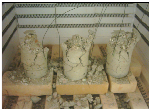
Rys. 1. Próbki betonu klasy C30/37 po wygrzaniu w temperaturze 1000°C [7]
