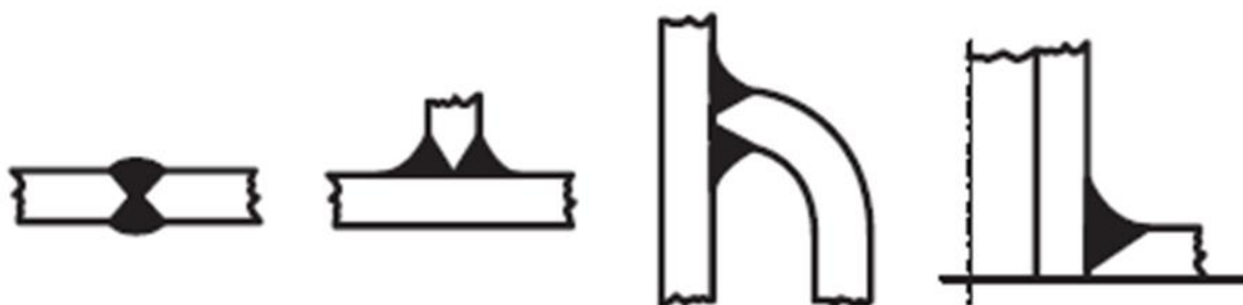
Rys. 5. Przykłady prawidłowych spoin Fig. 5. Examples correct weld
