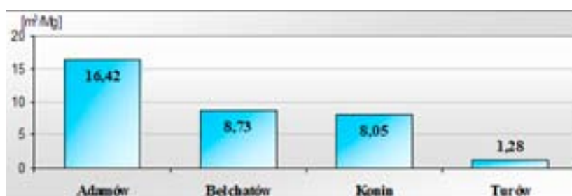
Rys. 9. Średni wskaźnik zawodnienia dla poszczególnych kopalń od początku ich działalności do końca 2006 roku
