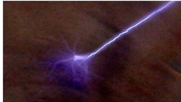
Fig. 5 A – płaszczyzny cięcia kryształów kwarcu dla pozyskania płytek wykazujących najlepsze właściwości piezoelektryczne (wg. http://pl.wikipedia.org/wiki/Piezoelektryki#Kwarc._CE.B1 ), B – iskra otrzymana z kwarcu piezoelektrycznego. Powiększenie 10 x.
