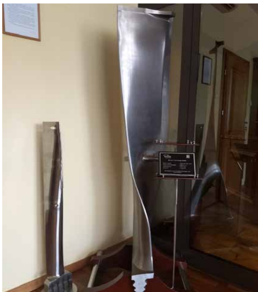
Rys. 3. Porównanie łopatek: 38 calowa łopátka ostatniego stopnia części NP bloków 500 MW i 60 calowa łopátka ostatniego stopnia części NP bloku 1075 MW
