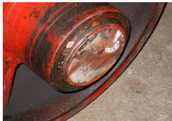
Rys. 3. Uszkodzenia mechaniczne: a) łożyska walczkowe walcowe, b) urwana końcówka wału silnika [1]
