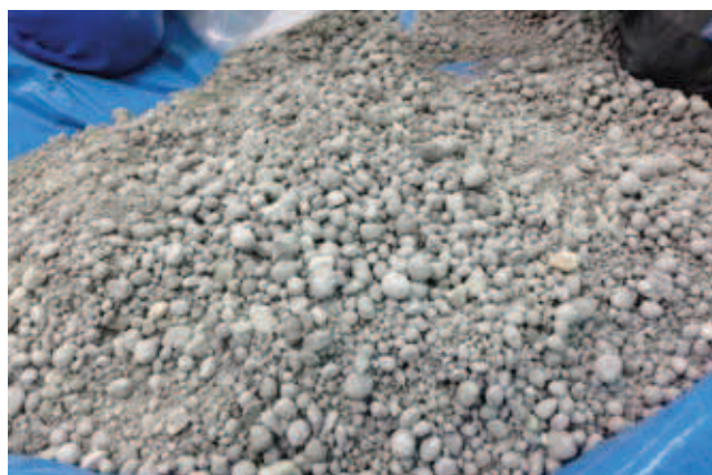
Rys. 3. Wygląd granulatu powstałego po utylizacji mieszanki: a) bezpośrednio po rozładunku, b) po 24 godzinach dojrzewania
