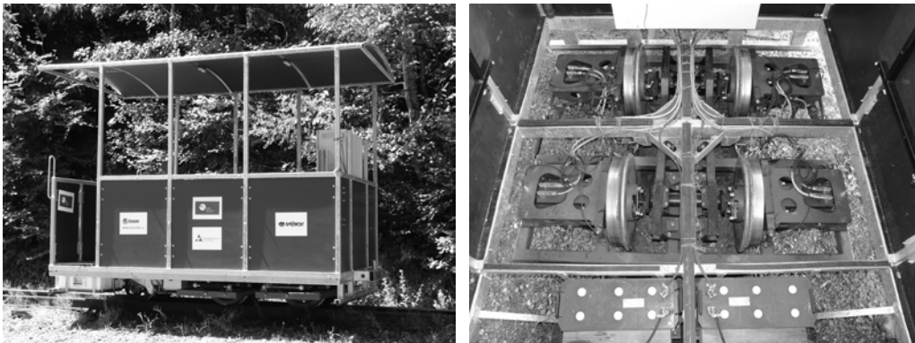
Fig. 3. Experimental vehicle at the railway line and bogie detail Bild 3. Experimentelle Fahrzeug an der Eisenbahnlinie und Fahrzeugchassis
