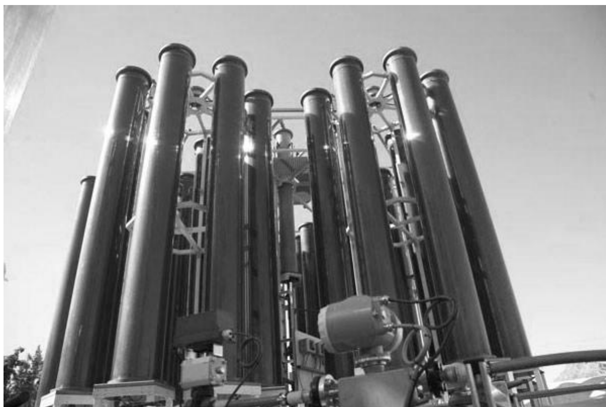
Rys. 4.3. Fotobioreaktory z glonami umieszczone w rejonie miasta Alicante (na południu Hiszpanii), właściciel firma Bio Fuel Systems (BFS) [41]. [Źródło: http://bfs-france.com/ ]
