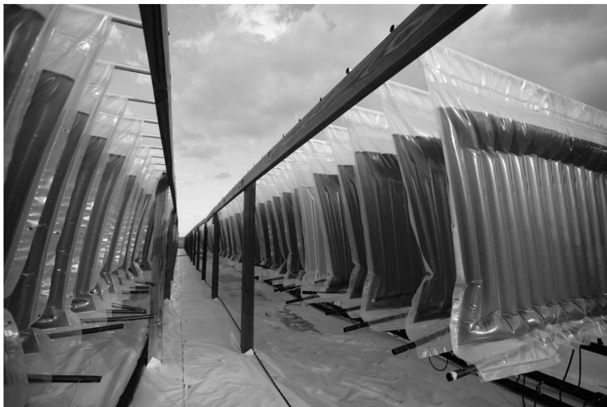
Rys. 4.2. Farma hodowlana cyjanobakterii umieszczonych w fotobioreaktorach z tworzywa sztucznego, właścicielem biorafinerii jest firma Algenol (Fort Myers na Florydzie) [36]. [Źródło: http://www.algenol.com/media/media-gallery ]
