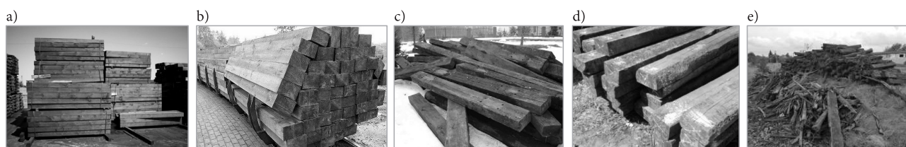
Rys. 3. Widok impregnowanych podkładów (podrozdnic): drewnianych (a, b) oraz zdemontowanych z linii kolejowej po wyeksploatowaniu (c, d, e) [3]
