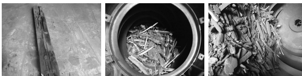
Rys. 9. Produkty stałe uzyskane po procesie rozkładu termicznego podkładów kolejowych [2]
