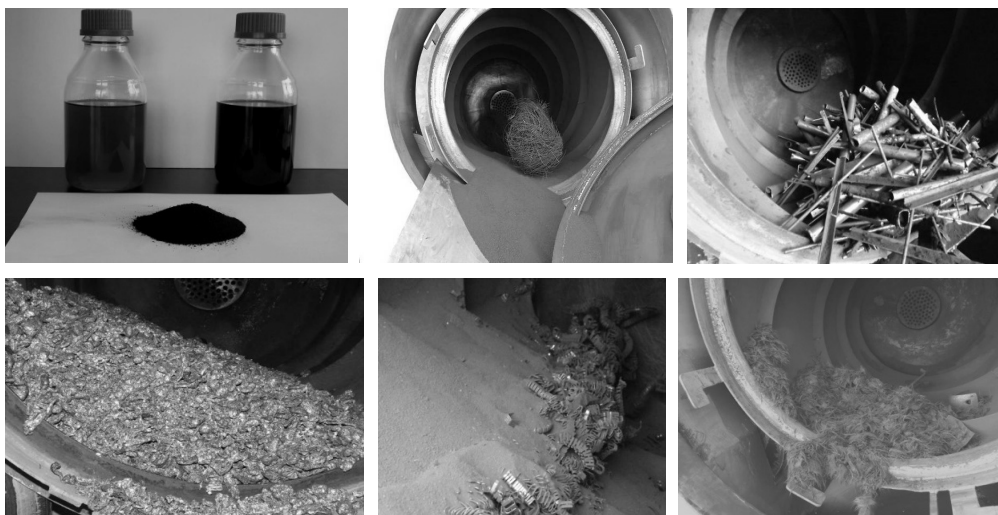
Rys. 8. Przykładowe produkty uzyskiwane w procesie rozkładu termicznego różnorodnych odpadów (oleje palne, karbonizat, złom stalowy / metalowy, folia aluminiowa) [2]
