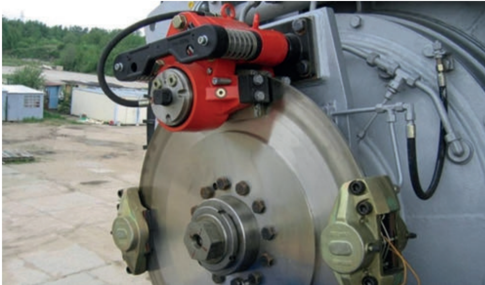
Fig. 8. Shoe brake immobilizing solar wheel of the main transmission of the bucket wheel drive in BWE KWK 910 at lignite open pit mine Turów [15] Rys. 8. Sprzęgło przeciążeniowe szybko odcinające nadwyżki dynamiczne procesu urabiania napędu koła czerpakowego koparki kołowej KWK 910 w KWB Turów [15]
