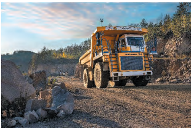
Rys. 13. Wozidło sztywnoramowe Bielaz 75454
