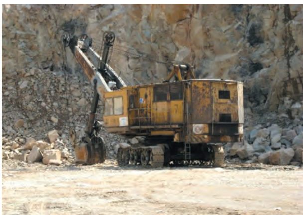
Rys. 9. Jednonaczyniowa linowo-elektryczna koparka przedsiębiorna Skoda E-303
