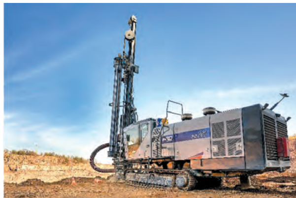
Rys. 6. Wiertnica Furukawa podczas wiercenia
