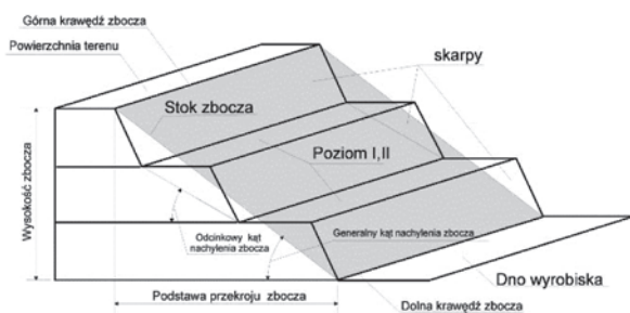
Rys. 4. Elementy budowy zbocza kopalni odkrywkowej
