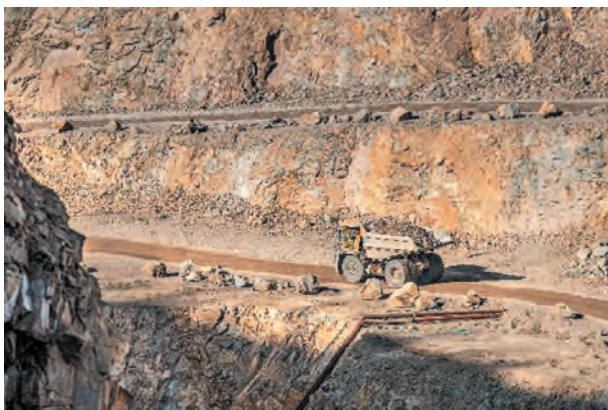
Rys. 12. Wozidło sztywnoramowe Bielaz 7547
