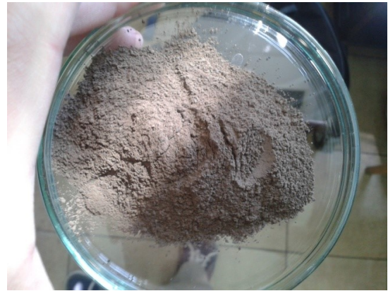
Fig. 4. Powdered flash slag
