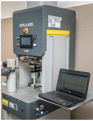
Rys. 2. Prasa żyratorowa (a) i szkic procesu zagęszczenia próbki w prasie żyratorowej (b) (F- siła ściskająca, n – liczba obrotów na minutę wokół osi próbki)
