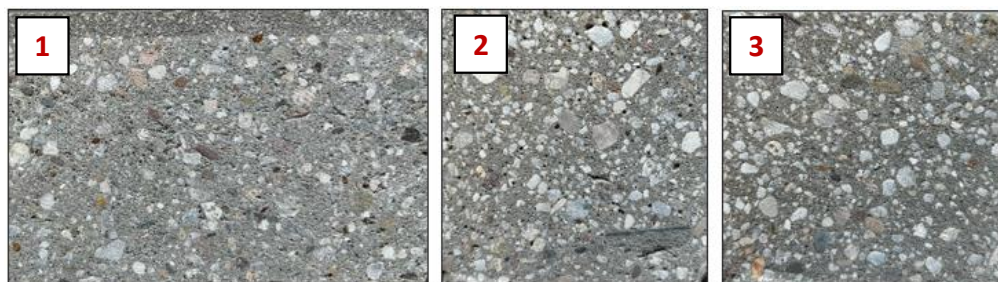
Rys. 1. Wpływ sposobu formowania na stopień zagęszczenia próbki. 1 – wibroprasowanie, 2 – stolik wibracyjny, 3 – prasa żyratorowa
