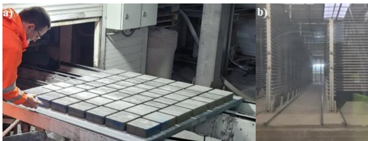
Fot. 1. Kontrola wizualna wyprodukowanej betonowej kostki brukowej przed wejściem do komory dojrzewalnej (a) Komora dojrzewalnej z regulowaną wilgotnością i temperaturą dojrzewania betonu (b)
