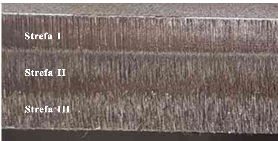
Rys. 5. Powierzchnia po cięciu laserem
