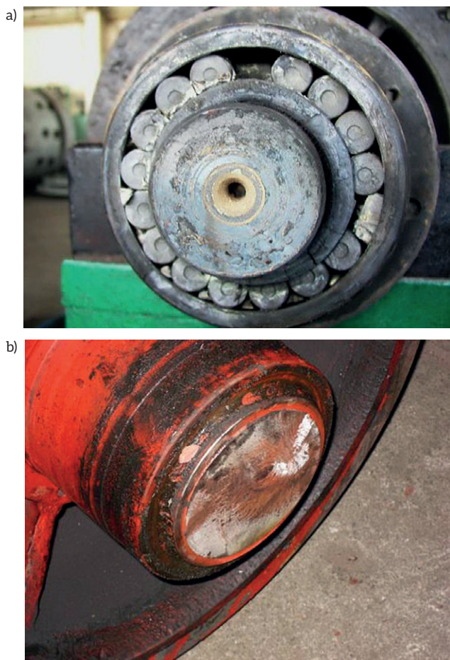
Rys. 3. Uszkodzenia mechaniczne: a) łożyska wałeczkowe walcowe, b) urwana końcówka wału silnika [1]
