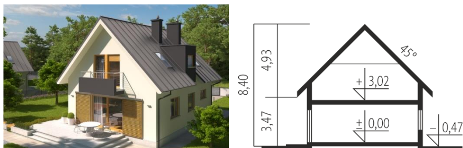
Rys. 1. Wizualizacja projektu domu i schemat przekroju [3]
