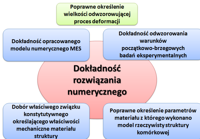
Rys. 3. Schemat ideowy czynników determinujących dokładność odwzorowania procesu deformacji regularnych struktur komórkowych za pomocą metody MES
