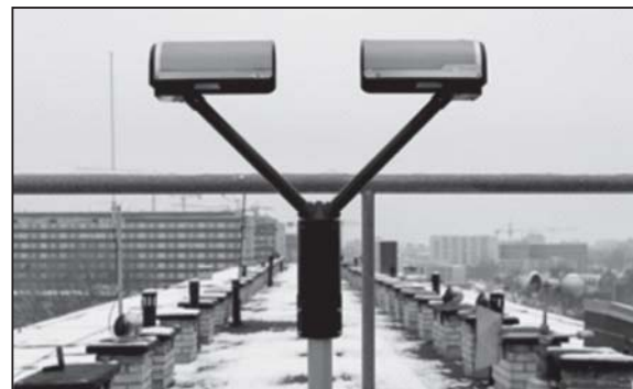
Rys. 1. Widok disdrometru laserowego OTT Parsivel2 na platformie obserwacyjnej w Warszawie
