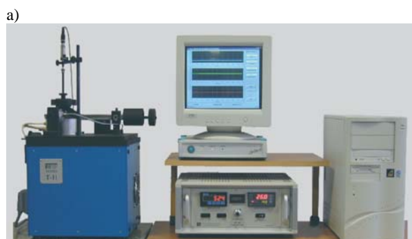
Rys. 1. Stanowisko badawcze: a) widok ogólny T-15, b) węzeł tarcia
