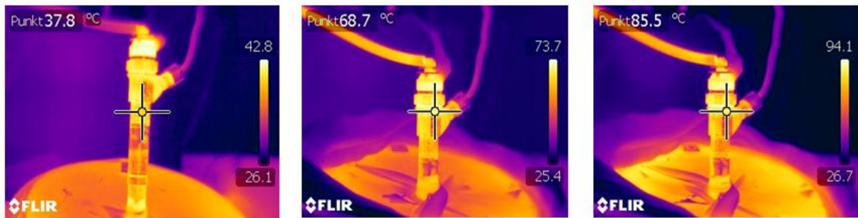
Rys. 8. Zmiana temperatury korpusu wtryskiwacza 4 - sprawný
