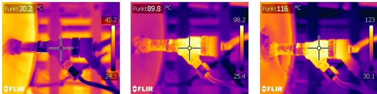
Rys. 9. Zmiana temperatury korpusu wtryskiwacza 3 - niesprawný
