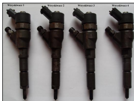
Rys. 2. Obiekty badań: wtryskiwacz 1 – 3 – wtryskiwacz uszkodzony, wtryskiwacz 4 – wtryskiwacz sprawny
