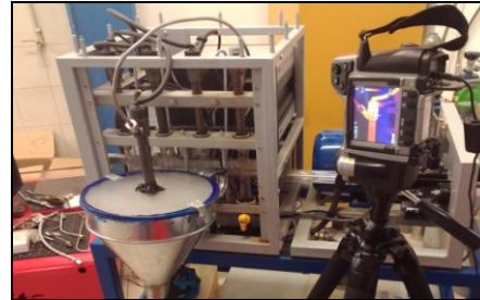
Rys. 4. Stanowisko badawcze z zamontowanym wtryskiwaczem
