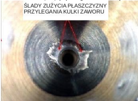
Rys. 3. Uszkodzenie gniazda zaworu sterującego [3]
