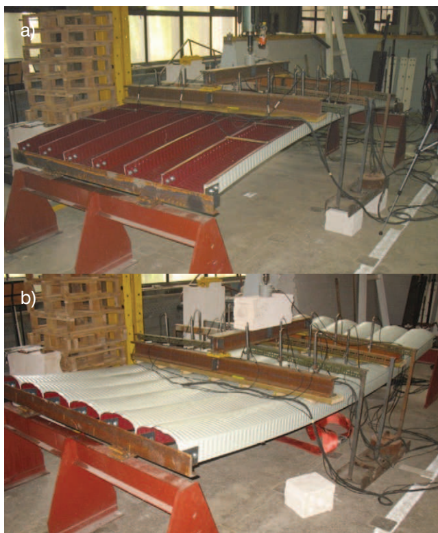
Rys. 4. Stanowisko badawcze dla elementów zginanych: a) łuk wypukły, b) łuk wklęsły
