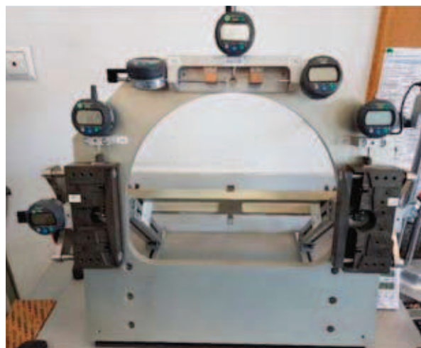
Rys. 2. Zespalone stanowisko pomiarowe wyposażone w czujniki zegarowe dotykowe
