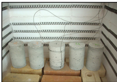
Rys. 2. Próbkę betonowe przygotowane do wygrzewania z zamontowanymi termoparami pomiarowymi [11]
