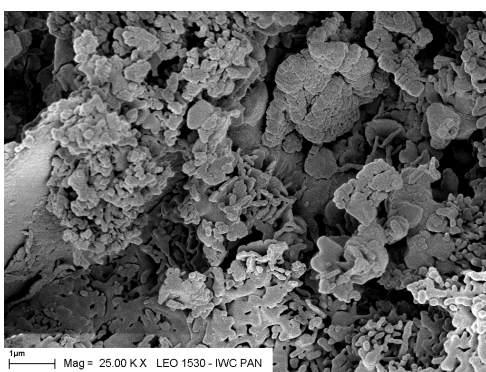
Rys. 17. 1F/800. Nowo powstałe produkty w zaczynie cementowym
