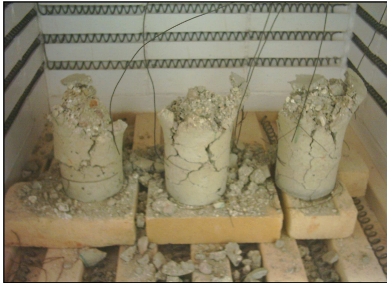
Rys. 5. Próbkki betonu klasy C30/37 po wygrzaniu w temperaturze 1000 °C [11]
