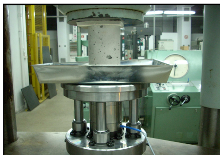
Rys. 3. Widok próbki betonowej przygotowanej do badania wytrzymałości [11]
