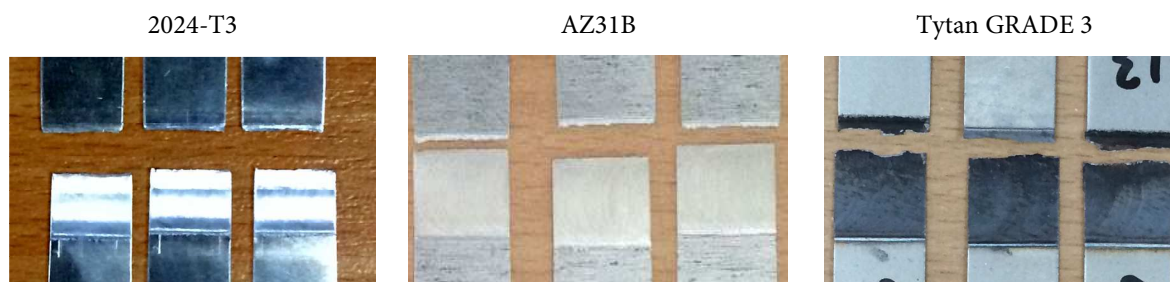
Rys. 17. Widoki próbek po wykonaniu badań wytrzymałościowych; dla wszystkich próbek zerwanie nastąpiło po stronie spływu Fig. 17. Views of sample after performing strength tests. For all samples, break on the retreating side
