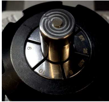
Rys. 6. Narzędzie z węglika wolframu zastosowane w procesie FSW przy zgrzewaniu blach stopu Al i Mg Fig. 6. Tungsten carbide tool used in the FSW process for welding Al and Mg alloy
