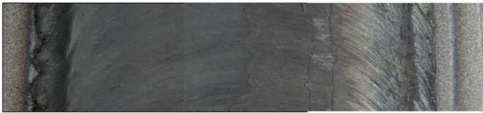
Rys. 18. Widoczne zaciąganie materiału w kierunku strony spływu zgrzeiny FSW stopu tytanu GRADE 2 grubości 0,4 mm
