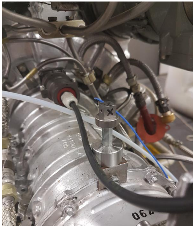
Zdjęcie 3. Akcelerometr trójosiowy użyty do pomiarów zamontowany na wlocie do sprężarki.
