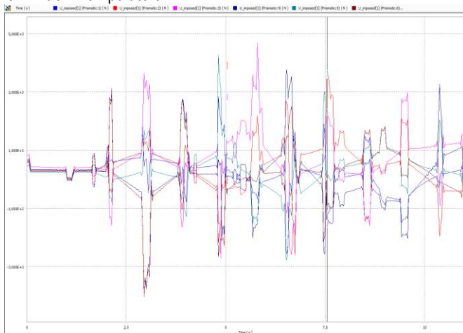
Rys. 11. Przebieg sił osiowych występujących w siłownikach
