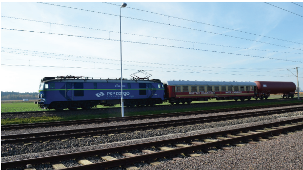
Rys. 6. Skład pomiarowy do badania układu hamulcowego wagonu cysterny [fot. autorzy]
