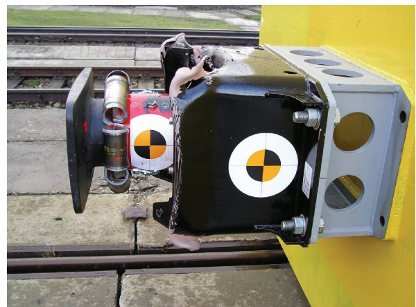
Rys. 8. Niszczące badania zderzeń na Torze Doświadczalnym [fot. autorzy]
