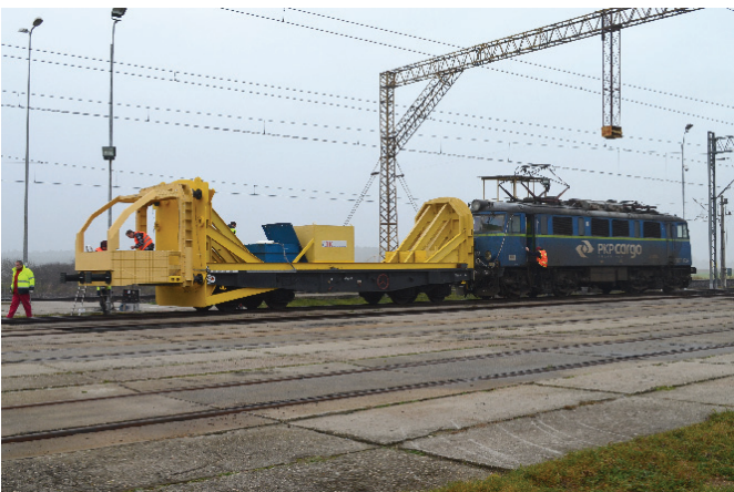
Rys. 8. Niszczące badania zderzeń na Torze Doświadczalnym [fot. autorzy]
