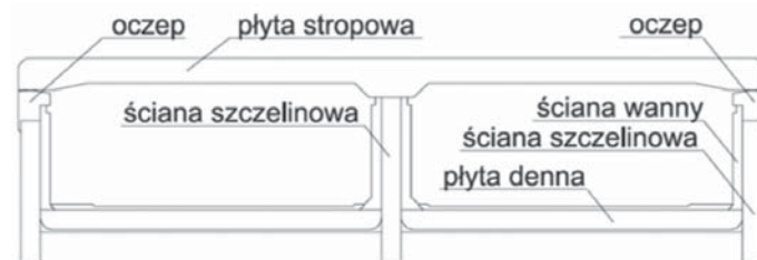
Rys. 3. Przekrój poprzeczny konstrukcji tunelu budowanego metodą stropową
