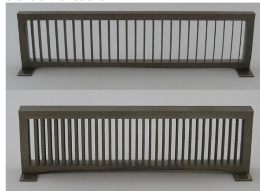
Rys. 5. Zdjęcia wykonanych modeli testowych dla elementów prętowych (góra) i cienkich ścian (dół)
