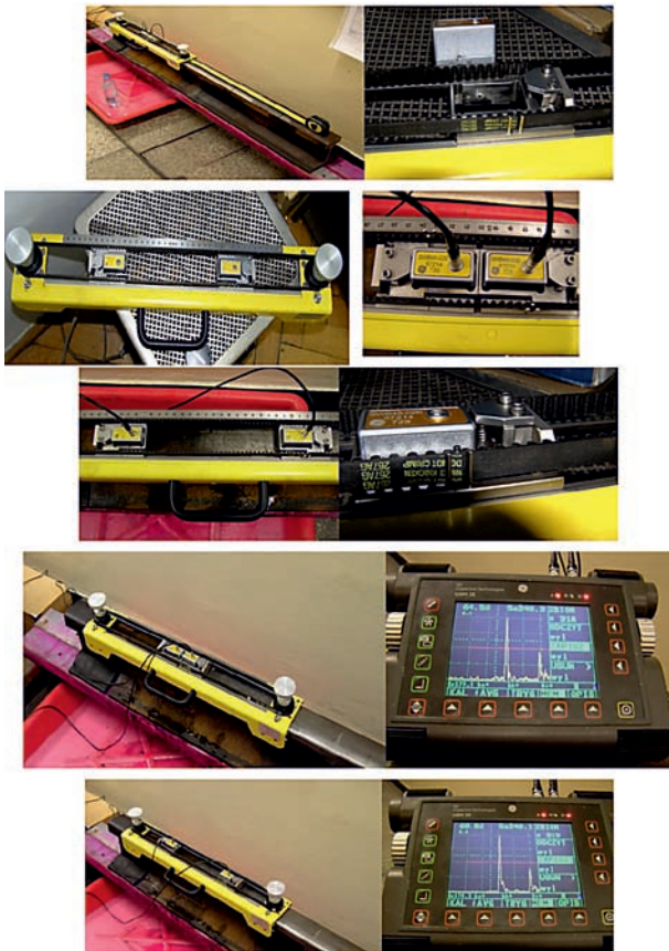
Rys. 7. Przyrząd do badania w technice tandem [3]. Fig. 7. The examination device in tandem technique [3].
