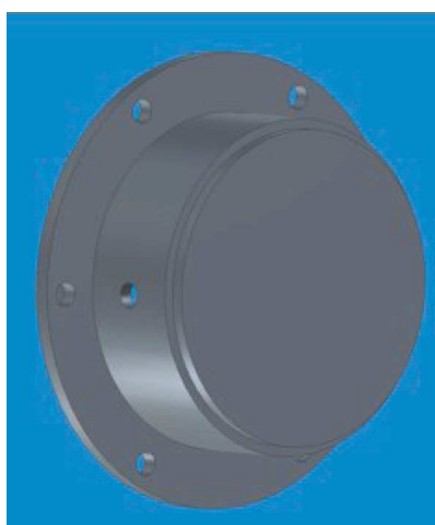
Rys. 12. Cylinder do wypełnienia medium uszczelniającym
