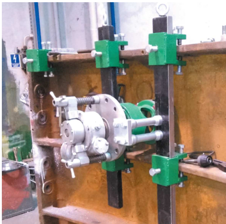
Rys. 4. Frezarka zamocowana do tubingów
