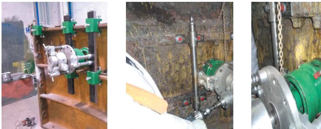
Rys. 9. Frezarka podczas prób wykonywanych na powierzchni
