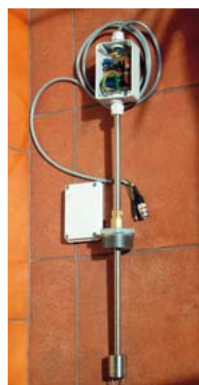
Rys. 6. Korozyjny czujnik rezystometryczny wraz z pomiarowym układem elektronicznym
