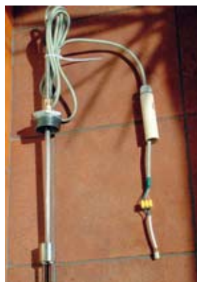
Rys. 5. Trójelektrodowy elektrochemiczny czujnik korozyjny
